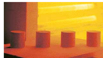
Carotte de Pierre Mammutti à une température de 940°C.
