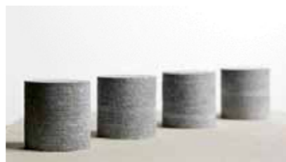
Carottes de Pierre Mammutti séchées à une température de 110°C.
