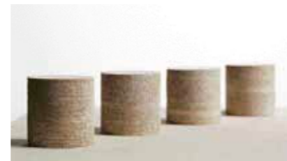
Les carottes de Pierre Mammutti, intactes après leur refroidissement. Le changement de teinte des carottes provient du fait que la magnésite se transforme en périclase au dessus de 500°C.
