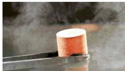
On immerge la carotte de Pierre Mammutti chauffée à une température extrême dans une eau courante à 20°C.
